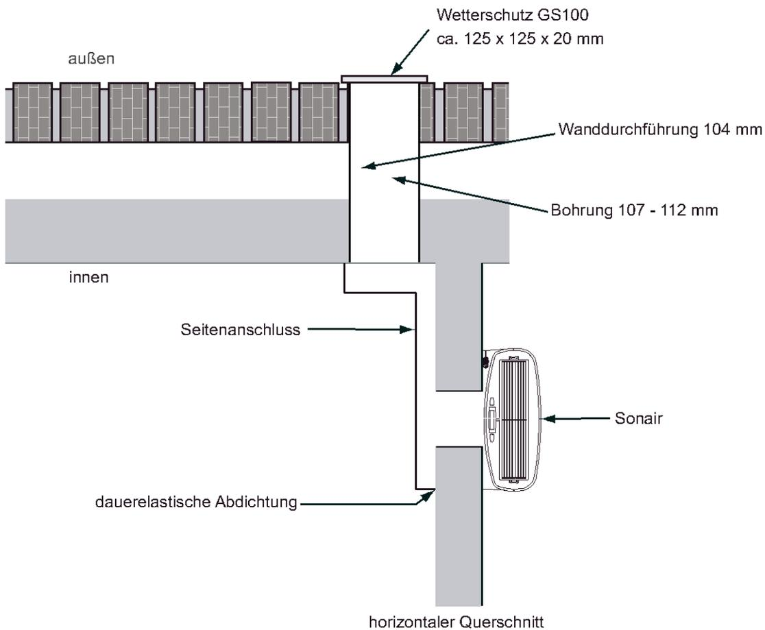
Prinzipdarstellung der Montage bei "Seitenwandmontage - Nebenraum".
